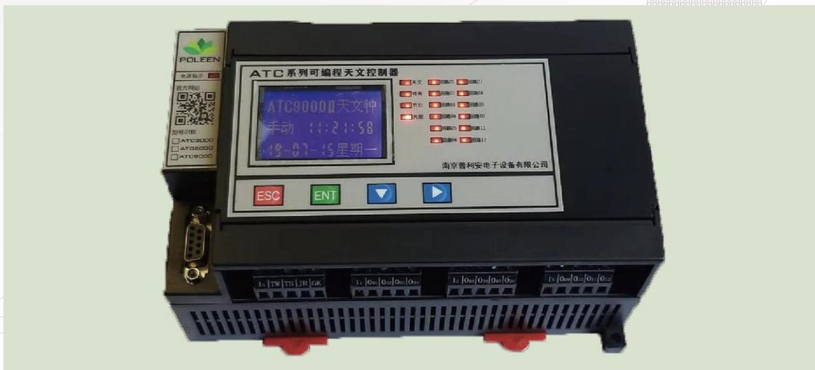
ATC系列可编程天文控制器，根据地理坐标可精确的计算出所在坐标地的天黑、天亮时间，精确控制照明的开启和关闭。配合光控弥补单纯时间控制的不足，做到按需照明，有效避免能源浪费。
