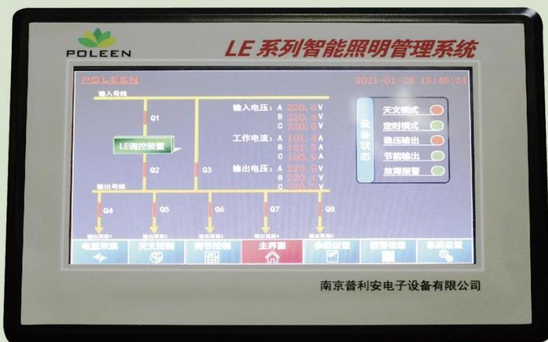
LE700系列照明管理系统，专业公共照明管理系统；产品集监测、控制、管理、保护、通讯于一体，采用工业级7英寸彩色液晶触摸屏、全中文操作、组态图形管理，人机界面友好，便于操作、维护；
